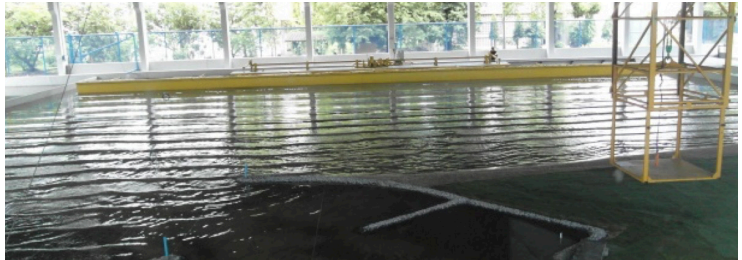
การทดลองจำลองคลื่นและชายฝั่งบริเวณปากแม่น้ำโลก และทดลองปรับปรุงปากแม่น้ำ ให้มีเสถียรภาพด้วยคันกันคลื่น (Breakwater)
