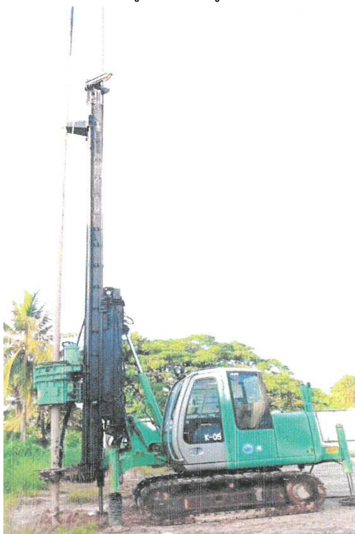
รูปที่ 7 รถเจาะเสาเข็มดิน-ซีเมนต์
